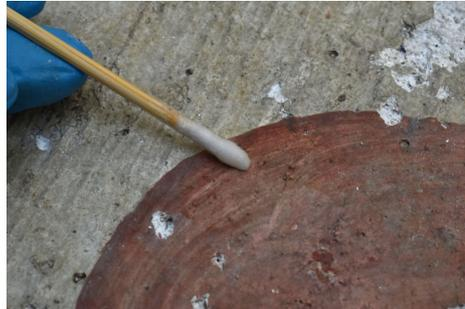
Fig. 12 - Test di resistenza dei colori
